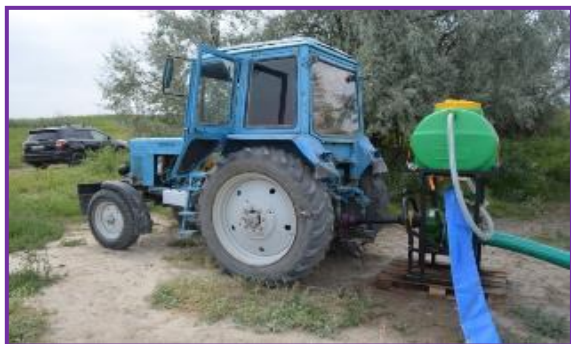
Фото 2. Центробежный насос MBN20 E с приводом от ВОМ трактора МТЗ-Р 150
