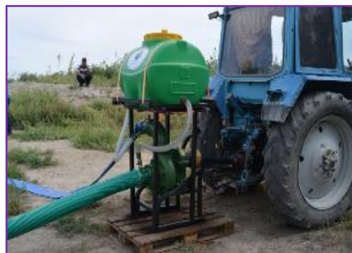
Фото 2. Центробежный насос MBN20 E с приводом от ВОМ трактора МТЗ-Р 150
